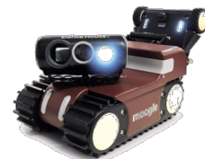
自走式床下点検ロボット
